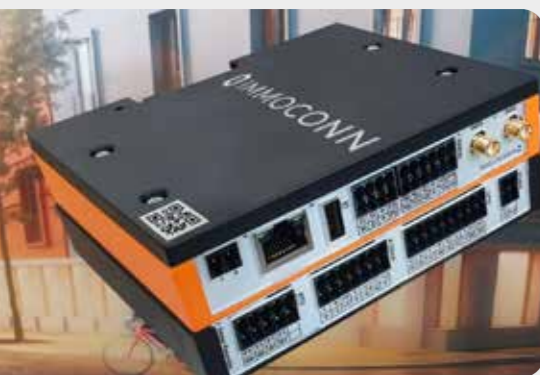
In diesen unscheinbaren Kästen verbirgt sich jene Technik, die eine Optimierung der Heizungsanlage ermöglicht.
